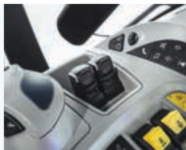
Accionamiento de hasta 7 distribuidores mediante levas
