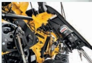
El compartimento para cuerda tiene capacidad máxima para 32 rollos. Los armarios de cuerda ahora son pivotantes, para una limpieza aún más fácil.
