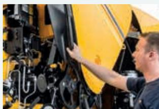
El capot delantero superancho y de una sola pieza permite acceder fácilmente a todas las piezas móviles y a los elementos de engrase y lubricación automática.
