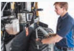
El sistema de lubricación centralizada Lincoln es fácil de inspeccionar y rellenar.
