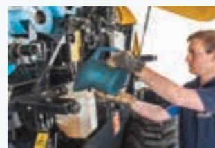
Cadenas lubricadas con aceite universal 10-40. Las escobillas de lubricación de las cadenas funcionan cada vez que se abre la compuerta trasera de la empacadora.
