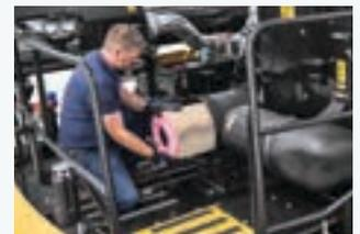
Al filtro de aire se accede fácilmente desde la plataforma del motor.
