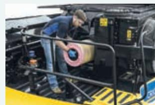
Al filtro de aire se accede fácilmente desde la plataforma del motor.
