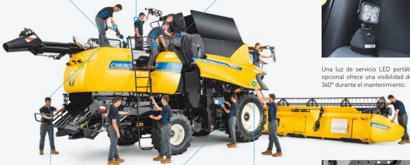
Al filtro de aire se accede fácilmente desde la plataforma del motor.
