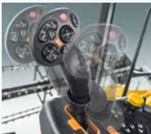
El movimiento basado en la fuerza le permite al operador cambiar de velocidad y de dirección.
