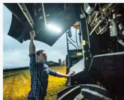
El nuevo conjunto de luces LED situado en la protección inferior facilita aún más las tareas de mantenimiento con luz escasa.
