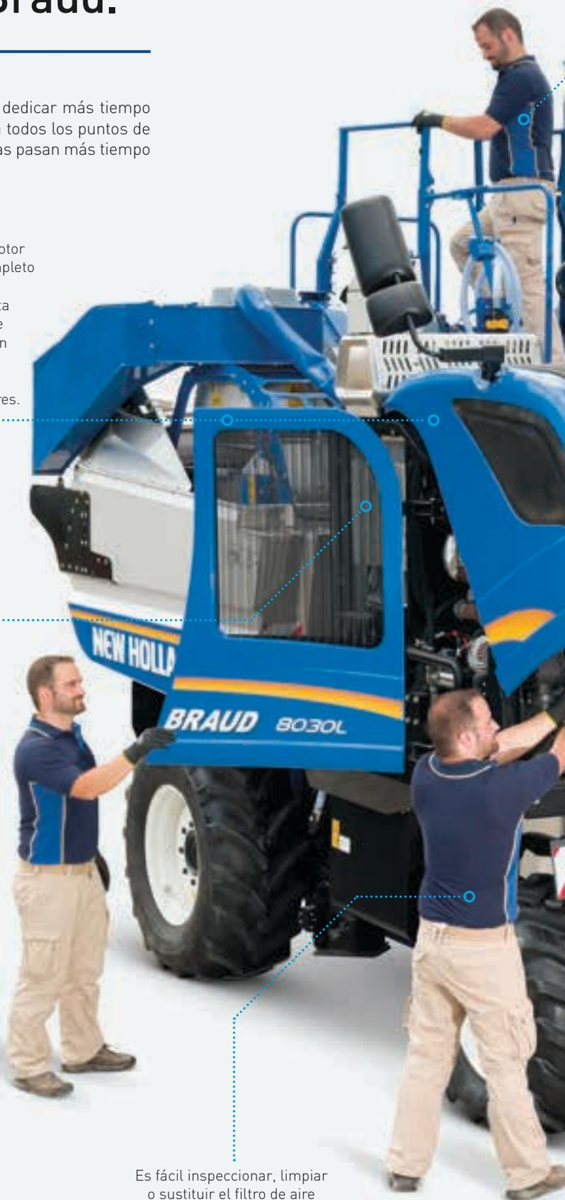
Es fácil inspeccionar, limpiar o sustituir el filtro de aire del motor sin necesidad de herramientas y desde el suelo.
