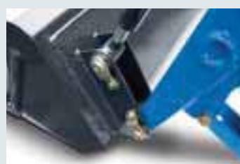
300TL: conexión del implemento mediante bulón
