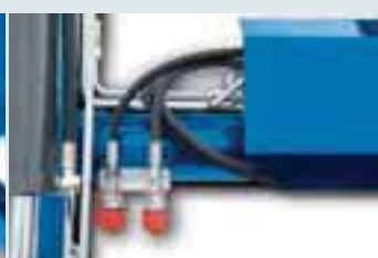
500TL: acoplamientos del tercer distribuidor
