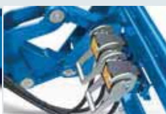
700TL: acoplamientos rápidos del tercer y cuarto distribuidor
