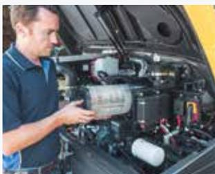
El capó del motor se eleva mediante muelles de gas para facilitar un acceso total.
