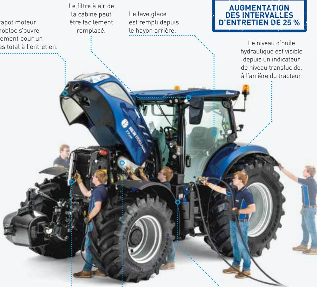
Le système de refroidissement s'ouvre vers l'avant pour un nettoyage plus rapide et plus facile.
