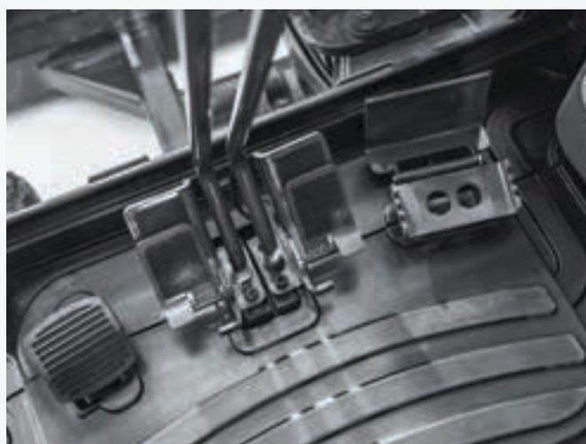
Des pédales de déplacement repliables sont installées sur tous les modèles sauf la E17C.
