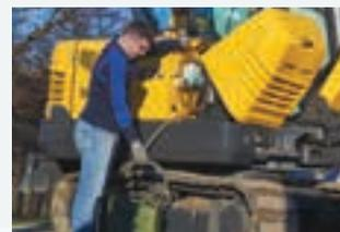
Une pompe électrique distante de rechargement est disponible en option sur les modèles E57C et E60C.
