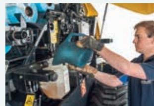
Chaînes graissées à l'huile 10-40 universelle. Les brosses de graissage des chaînes s'activent à chaque ouverture du hayon de la presse.
