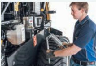
Le système de graissage centralisé Lincoln est facile à contrôler et simple à remplir.
