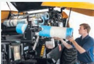
Le chargement de nouveaux rouleaux est simplifié au maximum pour limiter les temps d'arrêt.
