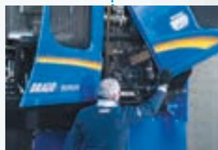
Le capot moteur constitué de deux éléments s'ouvre en grand pour permettre un accès total lors des travaux d'entretien : le capot avant bascule parfaitement afin d'accéder au moteur, la porte latérale s'ouvre avec un vérin pneumatique pour faciliter le nettoyage et l'entretien du système hydraulique et des refroidisseurs.
