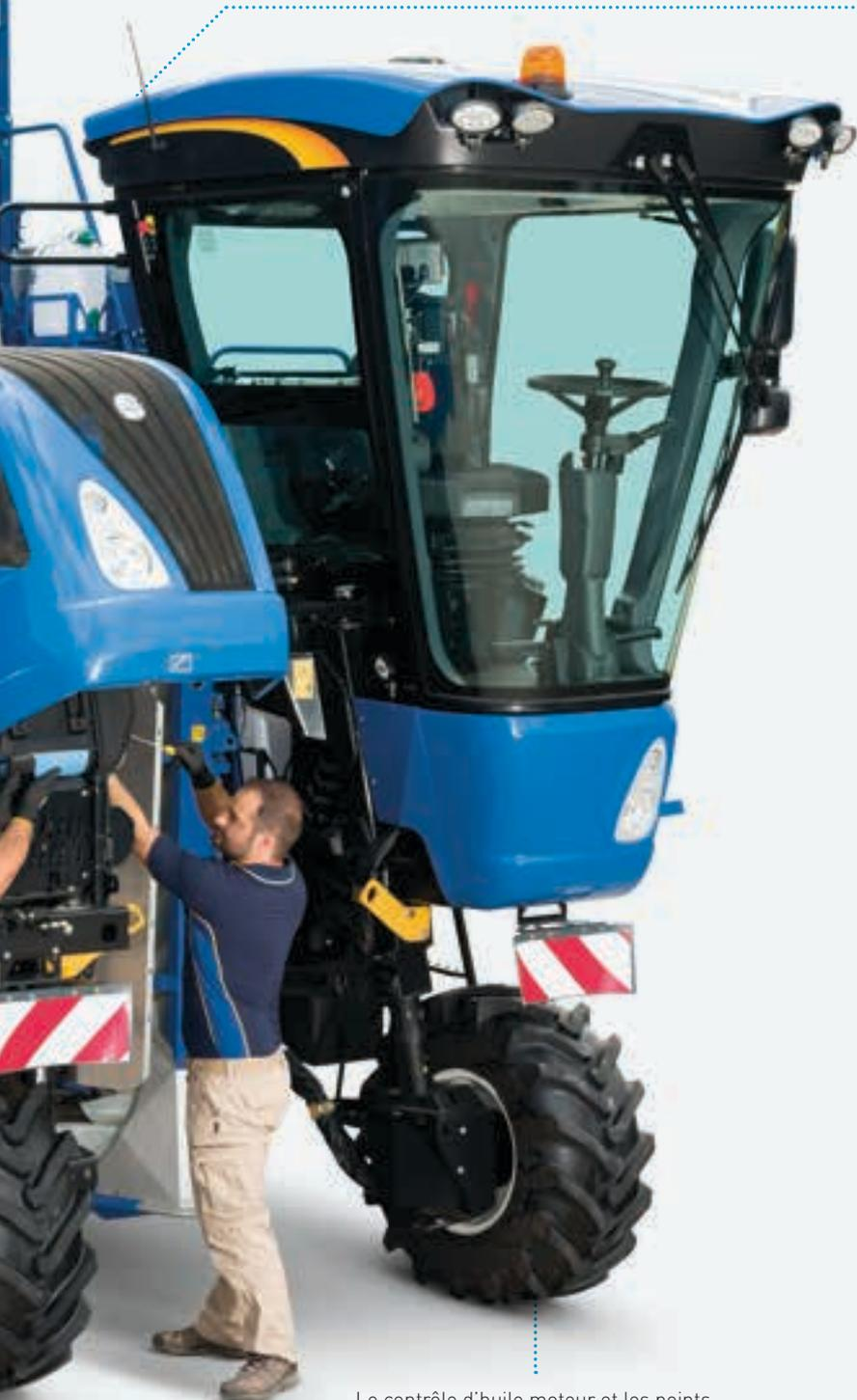
Le contrôle d'huile moteur et les points de remplissage sont faciles à atteindre pour des inspections de routine plus rapides et un entretien simplifié. Vous bénéficiez par ailleurs des intervalles d'entretien de 600 heures approuvés par New Holland.
