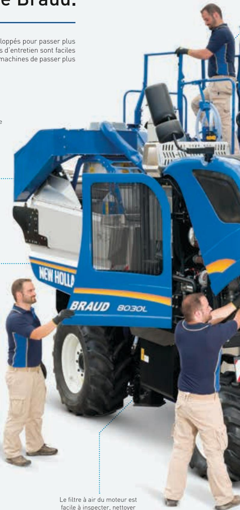
Le filtre à air du moteur est facile à inspecter, nettoyer ou changer. Aucun outil n'est nécessaire et l'accès se fait directement depuis le sol.
