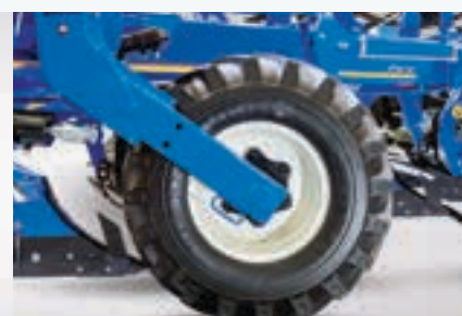
Roue combinée latérale 11,5-80-15,3 profil tracteur Réglage mécanique ou hydraulique, amortisseur hydraulique
