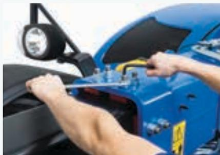
Le réglage des patins de la flèche télescopique a aussi été simplifié : une simple vis et un écrou frein rendent le réglage rapide et facile.
