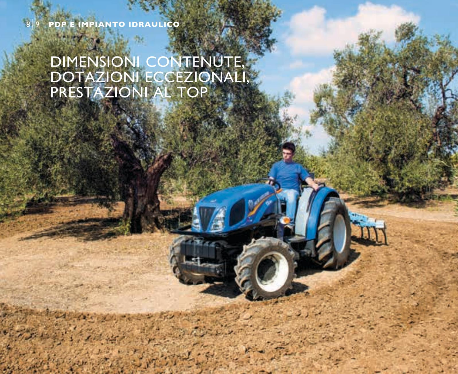
Più leggeri e più corti dei pluripremiati trattori specializzati serie T4F/N/V, i nuovi T3F non hanno nulla da invidiare ai loro "fratelli maggiori" in fatto di dotazioni. Sollevatore posteriore idraulico con due cilindri esterni, capacità fino a 2.277 kg, sistema Lift-O-Matic™ di serie. Due pompe separate per il circuito idraulico e il servosterzo. Fino a tre distributori idraulici ausiliari. PdP servoassistita fino a tre regimi.
