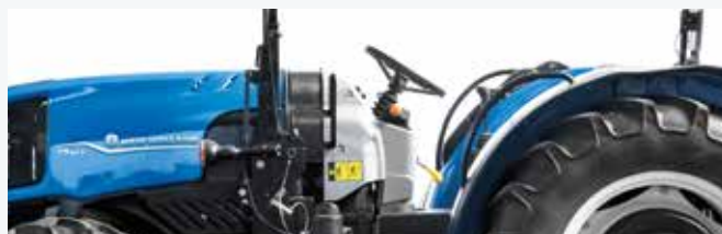
Struttura ROPS a montaggio centrale con ammortizzatore a gas, specifica per la frutticoltura
