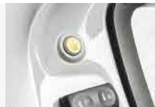
Pulsante di sicurezza per il disinnesto della PdP
