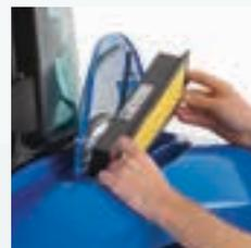
Il filtro dell'aria del motore è facile da controllare, pulire o sostituire, senza ricorrere ad utensili.
