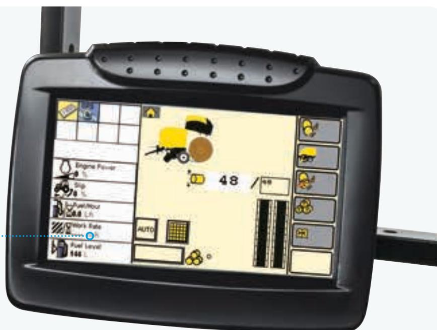
Interruttore intenzionale della PdP, che deve essere selezionato per mantenere la PdP in funzione quando si lascia il sedile di guida.
