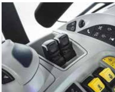
**Unità di controllo opzionale a due leve per i distributori idraulici ausiliari**
