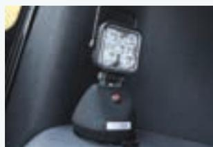
Un faro a LED optional portatile offre una visibilità a 360° durante le operazioni di manutenzione.
