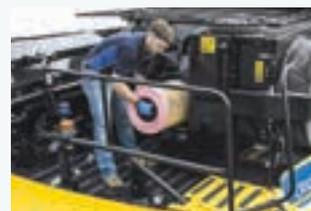
Il filtro dell'aria è facilmente accessibile dalla piattaforma del motore.
