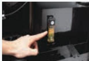
Tutti i filtri dell'olio e tutti gli scarichi dell'olio sono facilmente accessibili da terra e, insieme agli ingrassatori centralizzati, agevolano la manutenzione.
