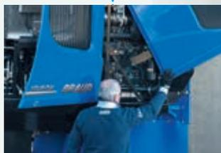
Il cofano motore in due pezzi è completamente apribile per la massima assistibilità: il frontale si ribalta perfettamente per consentire l'accesso al vano motore, mentre il portellone laterale scorre facilmente grazie all'ammortizzatore a gas e facilita la pulizia e la manutenzione dell'impianto idraulico e dei radiatori.
