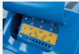
Per facilitare e ridurre gli interventi di manutenzione, tutti i punti di ingrassaggio sono raggruppati e facilmente accessibili dalla piattaforma della testata.
