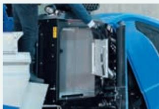
Il modulo di raffreddamento è facilmente accessibile per facilitarne e velocizzarne la pulizia.
