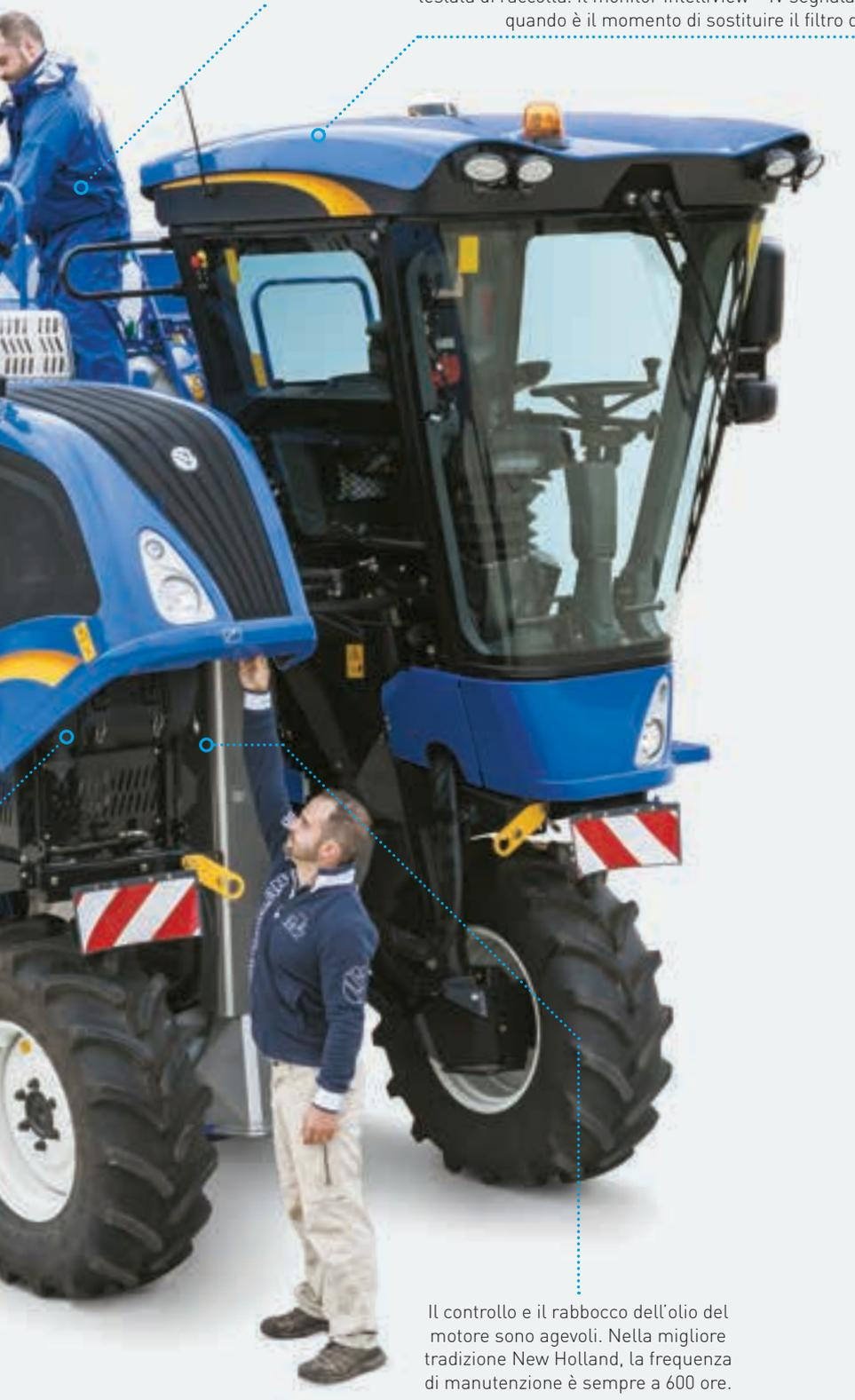
Il controllo e il rabbocco dell'olio del motore sono agevoli. Nella migliore tradizione New Holland, la frequenza di manutenzione è sempre a 600 ore.
