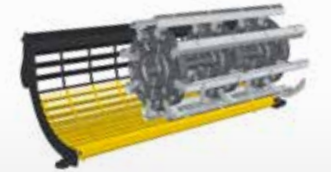
UNIVERSELE TROMMEL, STANDAARD DORSBLOKKEN EN KLEINE RIJSTDORSKORF
