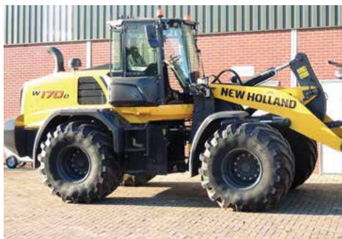
Vlak achter de cabine en voor en boven de motor ligt het koelpakket met standaard omkeerventilator. Door deze positie ervaren gebruikers minder vervuilde radiateurs.
