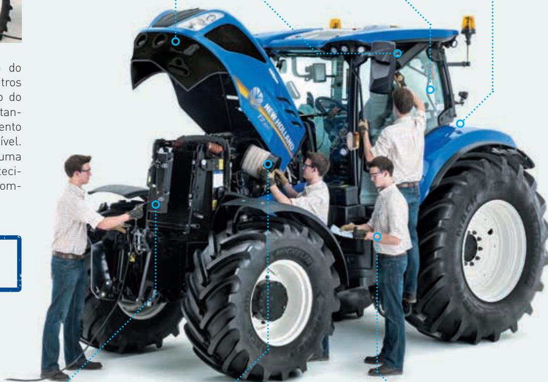
O sistema de refrigeração abre-se para permitir uma limpeza rápida e fácil.
