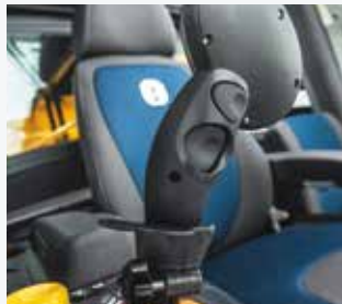
Växlingsknapp och upplåsning av körhastighet (bakom).
