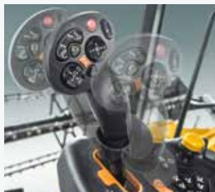
Kraftbaserad rörelse gör att föraren kan ändra hastighet och riktning.
