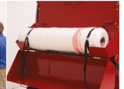
Se puede almacenar un segundo rollo inactivo de envoltura de red en la parte trasera de la empacadora.
