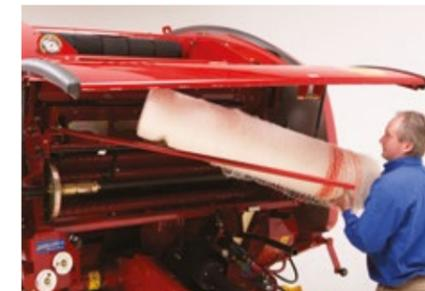
Se puede almacenar un rollo no activo de envoltura de red en la parte delantera de la empacadora encima del rollo activo.
