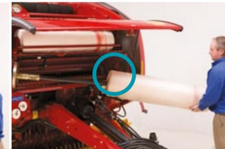
Un rollo activo de envoltura de red se carga fácilmente utilizando el tubo de red
