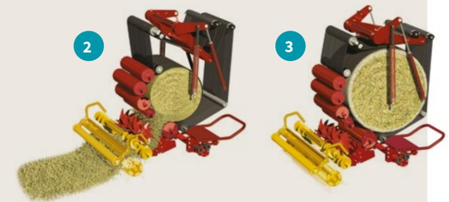
A medida que la paca crece, los rodillos superiores (G y H) giran hacia adelante. El brazo tensor de la correa (I) también gira para permitir que la cámara de empacado se expanda. El cilindro de tensión de la correa (J) y el resorte de tensión de la correa (K) reducen la tensión de la correa al principio para garantizar una formación positiva del núcleo, incluso al empacar cultivos cortos y secos.
