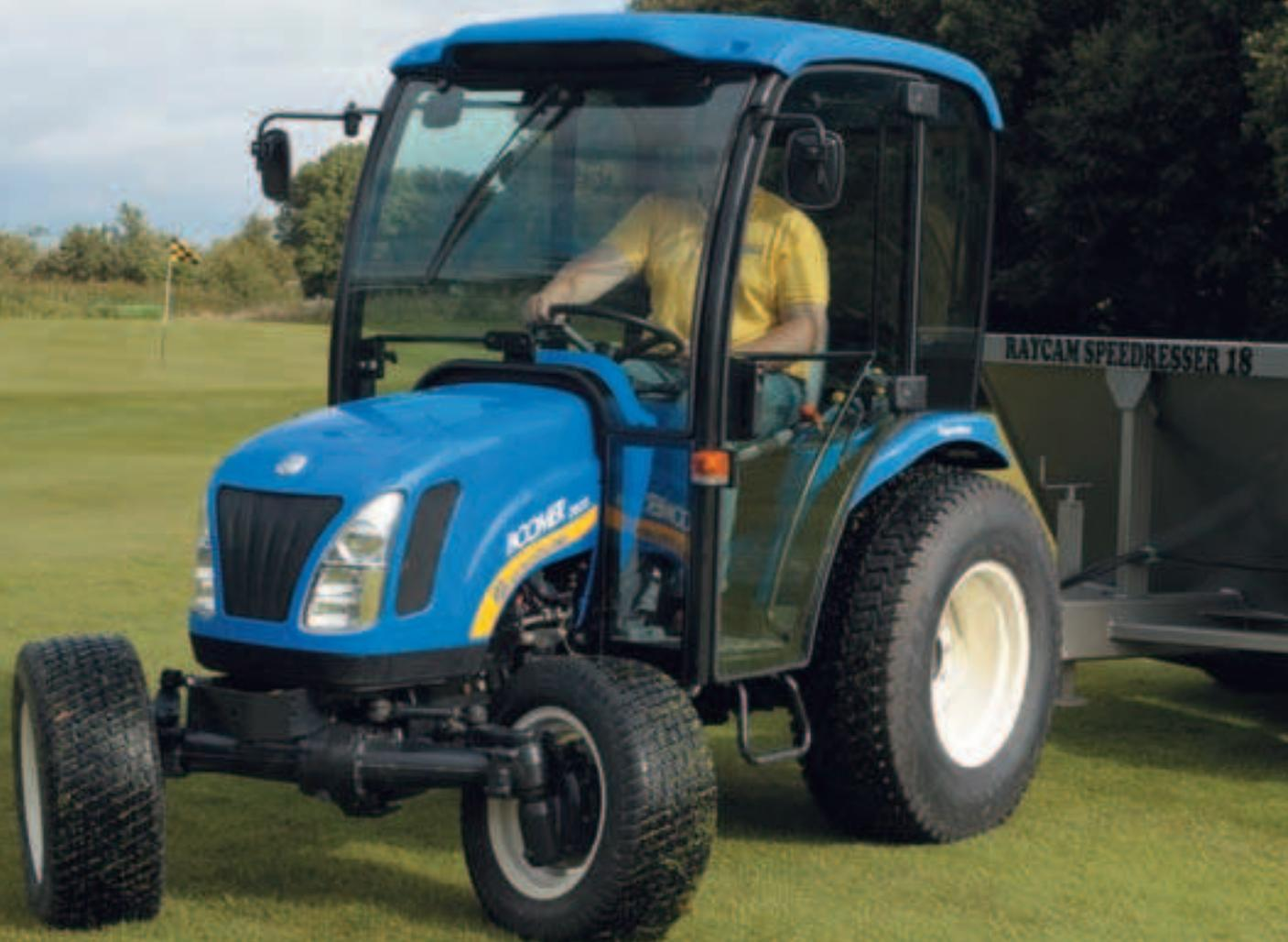
Los tractores Boomer 2030 y 2035 pueden incorporar soluciones avanzadas que incluyen una cabina de gran confort, el eje SuperSteer™ para realizar giros cerrados y la gestión automática de la tracción Sensitrak. Una transmisión hidrostática de tres gamas, con la opción mecánica de 9x3 disponible para el modelo Boomer 2030. Todas ellas forman parte del inmejorable conjunto de características técnicas que ofrece New Holland.
