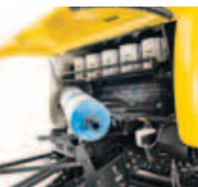
Apoyo integrado para sujetar un rollo de red al cambiarlo desde el nivel del suelo.
