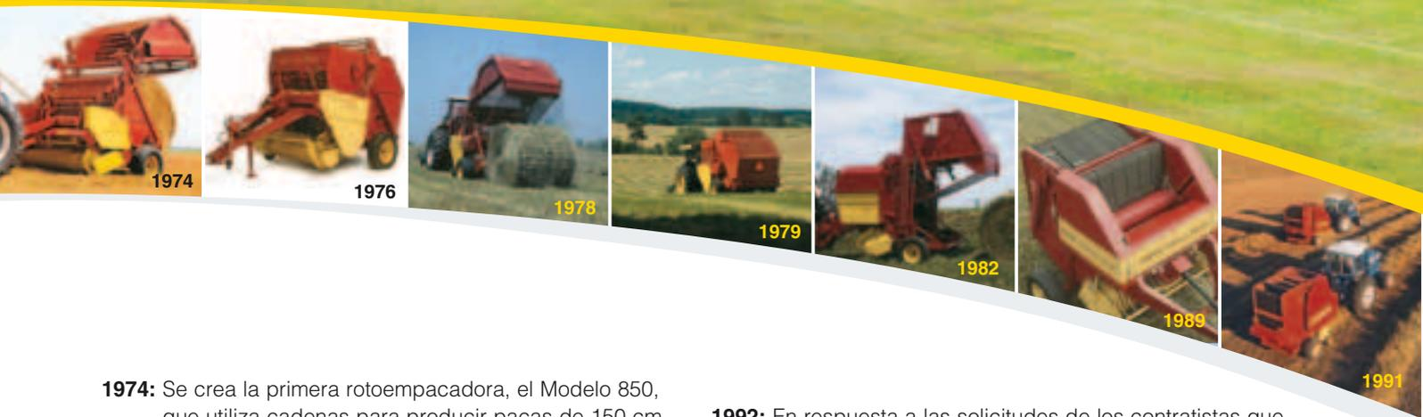
**1974:** Se crea la primera rotoempacadora, el Modelo 850, que utiliza cadenas para producir pacas de 150 cm.
