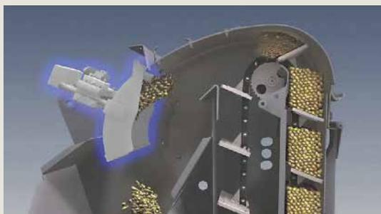
El exclusivo sensor de rendimiento de New Holland genera mediciones de flujo de grano extremadamente precisas. Además solo necesita una calibración por cosecha.
