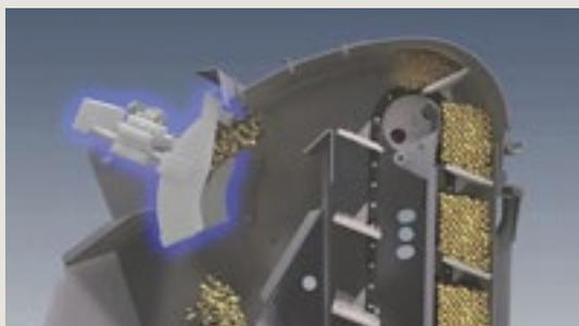
El exclusivo sensor de rendimiento de New Holland genera mediciones de flujo de grano extremadamente precisas. Además solo necesita una calibración por cosecha.
