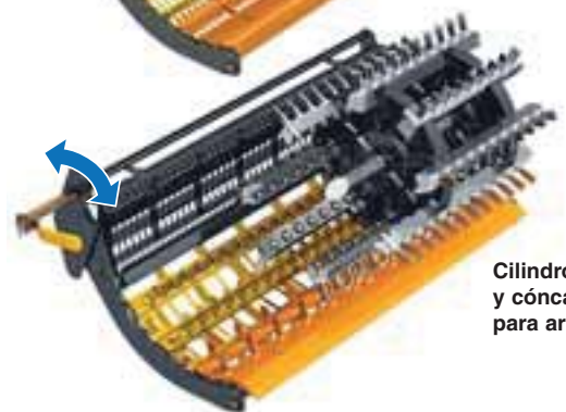
Cilindro estándar y cóncavo por secciones para maíz
