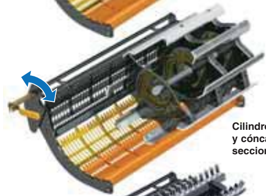
Cilindro estándar y cóncavo por secciones para cereal
