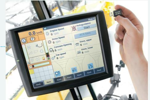
Los paquetes de agricultura de precisión de New Holland le permiten ajustar los insumos a su medida para reducir costes y aumentar el rendimiento. La máquina registra esta información en tiempo real durante el trabajo y el paquete informático del monitor IntelliView™ IV la transmite de forma sencilla y eficaz al ordenador para su análisis a través de un dispositivo USB complementario de 4 GB, con capacidad suficiente para recoger los datos de más de 600-700 hectáreas recolectadas.
