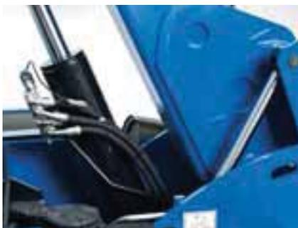
El cilindro hidráulico de compensación del brazo está situado en la parte trasera de este, cerca del punto de articulación. Como es habitual, el cilindro de elevación principal se encuentra bajo el brazo. A medida que el brazo se eleva, ambos cilindros se extienden, pero en sentido opuesto. Este «funcionamiento contrario» ayuda a mejorar el control del brazo y, entre otras ventajas, aumenta su estabilidad. El suave movimiento del brazo al subir y bajar reduce el esfuerzo y alarga la durabilidad.
