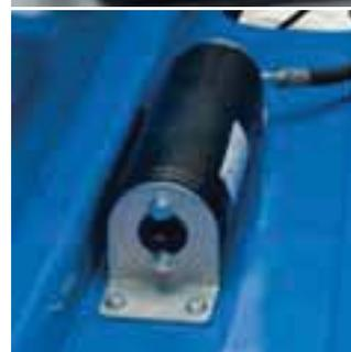
Es posible incorporar un sistema de suspensión del brazo. El sistema lo activa el operador y está diseñado para reducir las sacudidas cuando se trabaja en terrenos difíciles. Se desactiva automáticamente cuando el brazo sobrepasa un ángulo de elevación de  $35^\circ$ .
