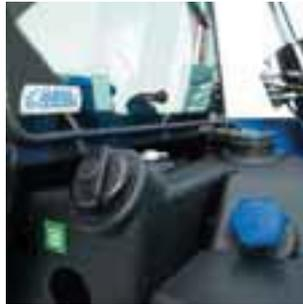
El depósito de combustible, de 140 litros, es accesible a través de una amplia boca de llenado, lo que permite repostar con latas en el campo cuando es necesario. Con una capacidad de 27 litros, el depósito de AdBlue® es lo suficientemente grande para durar al menos 5 llenados del depósito de combustible.
