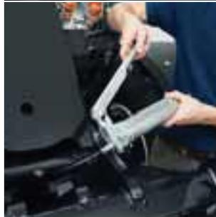
En los modelos Estándar solo hay nueve puntos de engrase diarios, mientras que en los Elite hay otros tres en el cabezal de implementos de alto volteo. Todos los puntos de engrase están diseñados para facilitar el acceso y, los que de otro modo serían difíciles de alcanzar, pueden engrasarse a distancia.
