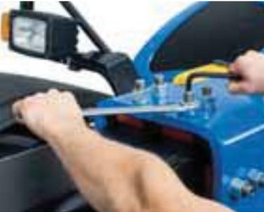
Se ha simplificado la antes ardua tarea de ajustar los amortiguadores del brazo telescópico: ahora es más fácil y rápida con un simple sistema de tornillo y contratuerca.
