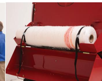
Se puede almacenar un segundo rollo inactivo de envoltura de red en la parte trasera de la empacadora.
