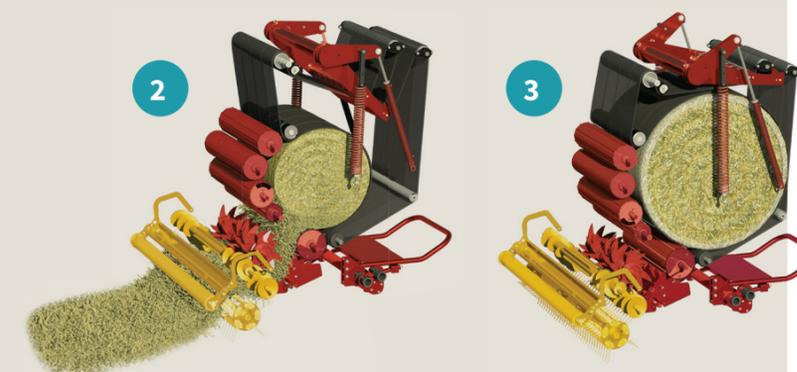
A medida que la paca crece, los rodillos superiores (G y H) giran hacia adelante. El brazo tensor de la correa (I) también gira para permitir que la cámara de empacado se expanda. El cilindro de tensión de la correa (J) y el resorte de tensión de la correa (K) reducen la tensión de la correa al principio para garantizar una formación positiva del núcleo, incluso al empacar cultivos cortos y secos.
