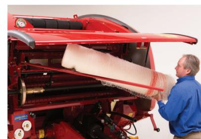
Se puede almacenar un rollo no activo de envoltura de red en la parte delantera de la empacadora encima del rollo activo.
