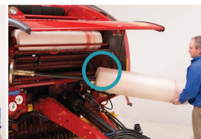
Un rollo activo de envoltura de red se carga fácilmente utilizando el tubo de red
