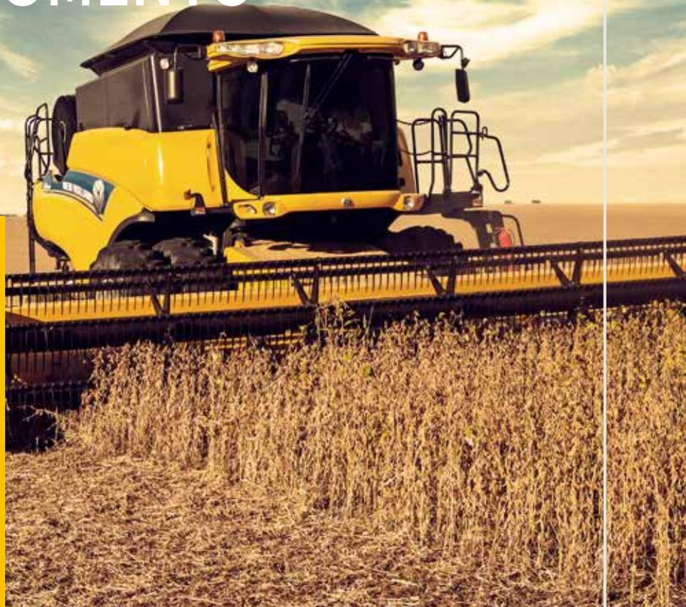
Usando un sensor montado en la correa de transmisión del elevador de paja, se mide la cantidad de material admitido en la máquina. En áreas donde la cosecha es más fácil, el IntelliCruise™ aumenta la velocidad de avance para que la cosechadora siempre funcione a la
