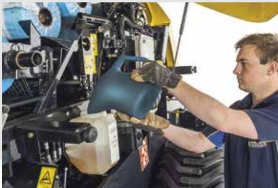
**Cadenas lubricadas con aceite universal 10-40. Las escobillas de lubricación de las cadenas funcionan cada vez que se abre la puerta trasera de la empacadora.**
