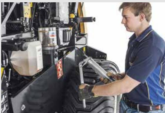
**El sistema de lubricación centralizada Lincoln es fácil de inspeccionar y rellenar.**
