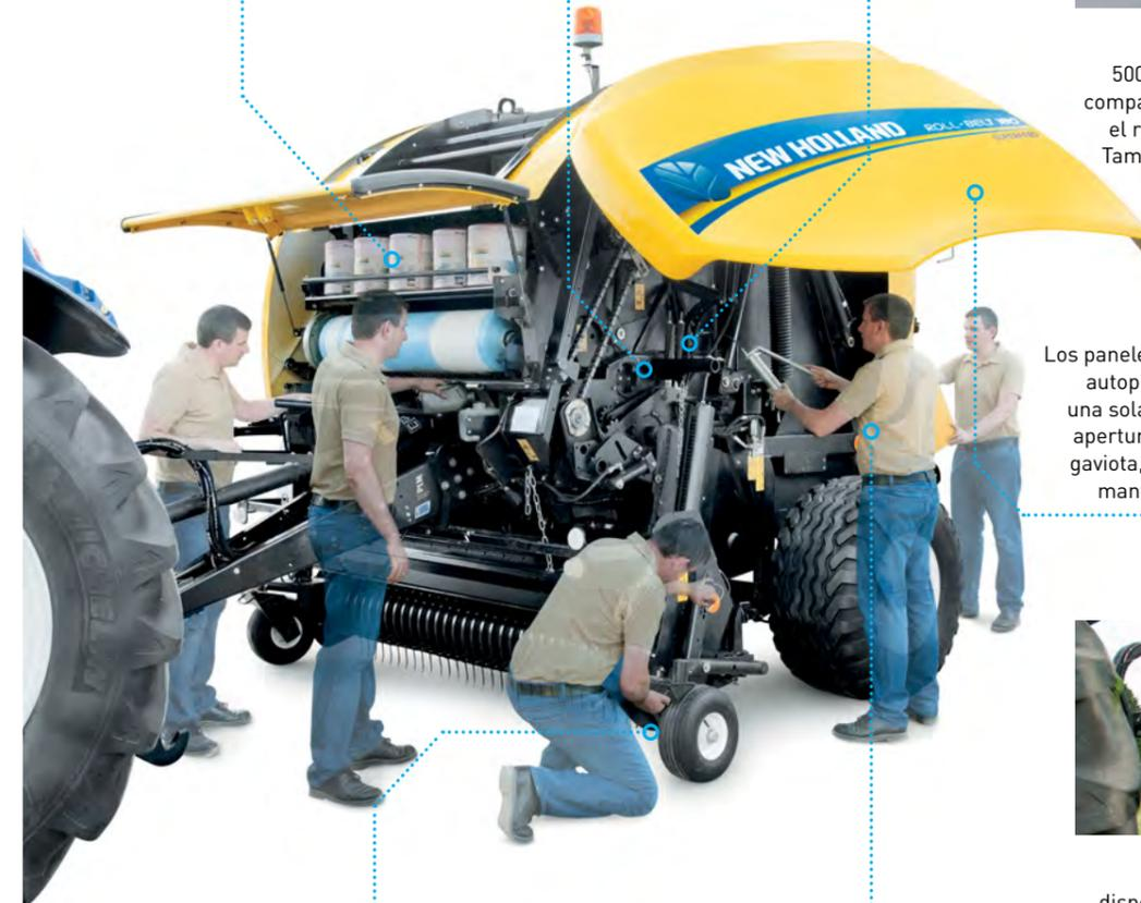
Los paneles laterales autoportantes de una sola pieza, con apertura en ala de gaviota, facilitan el mantenimiento.
