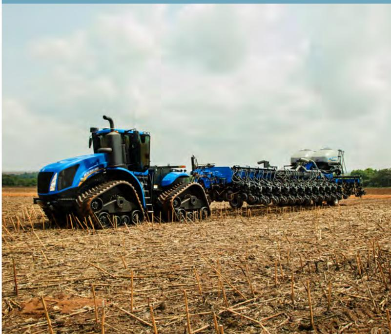
Las PL7000 5s en modo transporte tienen 6,10 m de ancho, lo que facilita el movimiento en los transportadores agrícolas.
