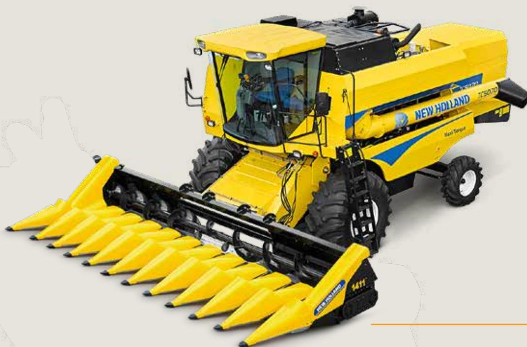
O ajuste manual do deck espigador permite adaptar a máquina para as condições do seu campo, sem prejudicar a performance da máquina. Sua chapa lateral perfurada protege a transmissão lateral, não interferindo na sua ventilação. Além disso, a abertura lateral basculante é de fácil acionamento.
