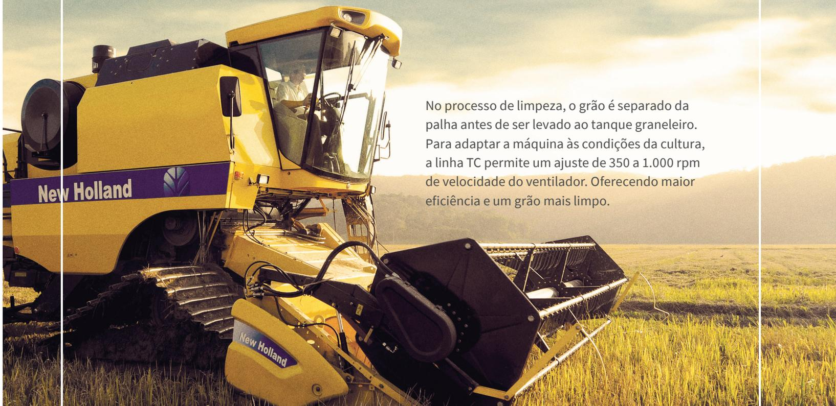
No processo de limpeza, o grão é separado da palha antes de ser levado ao tanque graneleiro. Para adaptar a máquina às condições da cultura, a linha TC permite um ajuste de 350 a 1.000 rpm de velocidade do ventilador. Oferecendo maior eficiência e um grão mais limpo.
