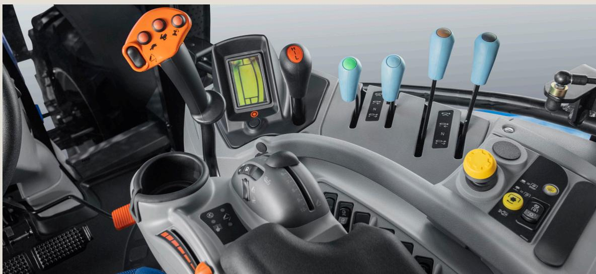
intuitivo monitor IntelliView™ IV, com informações sobre trator e implemento, possui função HTS (Headland Turn Sequence) para simplificar as operações graças às sequências automáticas de fim de linha, além disso o trator possui pré-disposição de piloto automático.
