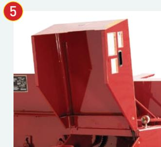
Les boucliers en acier vous donnent un accès facile aux points de service clés, comme la boîte d'engrenages et la pompe hydraformatique, la chaîne du système d'alimentation rotatif et le noeur.
