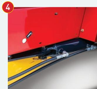
Bien que la flèche pivotante mécanique soit standard, vous pouvez également utiliser l'hydraulique pour faire pivoter la presse à balles en position de transport ou de travail rapidement et facilement. La flèche pivotante hydraulique est standard sur le Hayliner 275 PLUS et disponible en ensemble pour le Hayliner 265 et le Hayliner 275.
