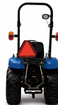
La TDF trasera y enganche de 3 puntos le permite enganchar un sinnúmero de implementos para cualquier trabajo.
