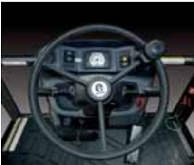
Disponible sur les modèles B110B et B115B, la transmission Powershift procure à l'opérateur un confort de conduite optimal. Utilisée en mode « tout automatique », elle permet de passer automatiquement au rapport supérieur ou inférieur en fonction de la vitesse et de la charge, améliorant les temps de cycle et facilitant les déplacements sur route.
