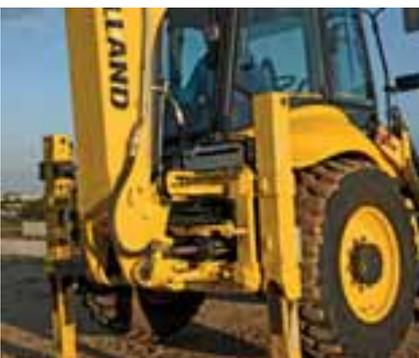
Déport latéral hydraulique (en option) : positionnement rapide et précis de la flèche sans risque pour le sol
