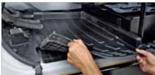
n Le tapis de sol en deux parties s'enlève facilement grâce à deux poignées. Sous le tapis, un trou d'évacuation facilite le nettoyage de la cabine.
