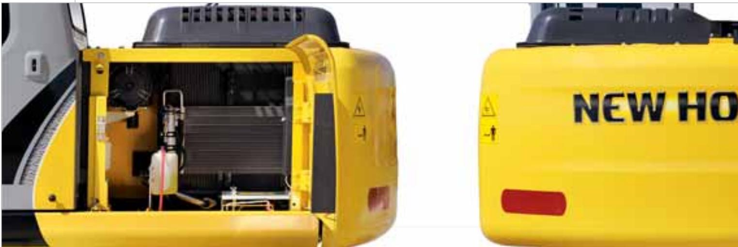
La disposition simplifiée de tous les composants essentiels de la New Holland E135B, sous les panneaux de gauche et de droite, rend la maintenance plus facile, plus rapide et moins onéreuse et offre un meilleur accès pour l'entretien courant. Il y a davantage d'espace dans les compartiments et la plupart des composants sont placés de manière à faciliter l'accès depuis le sol. **Une conception moderne et élégante associée à une technologie de pointe.**
