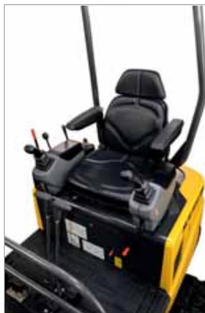
Un environnement de fonctionnement convivial pour l'utilisateur et conçu pour de longues journées de travail productif avec une fatigue minimale de l'opérateur: contrôle de translation actionné par levier ou pédale, tableau de bord facilement et complètement visible dans toutes les directions. Des leviers de commande de type « joystick » précis nécessitant peu d'effort pour une meilleure productivité.
