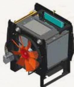
Sur la plupart des chargeuses sur pneus, les radiateurs sont montés dos à dos. Chez New Holland, nous avons choisi de les placer de sorte à former un cube. Cette configuration a pour avantage d'améliorer le refroidissement, même dans les environnements les plus rudes. Grâce au ventilateur réversible programmable de série, le nettoyage des radiateurs sera bientôt un lointain souvenir.
